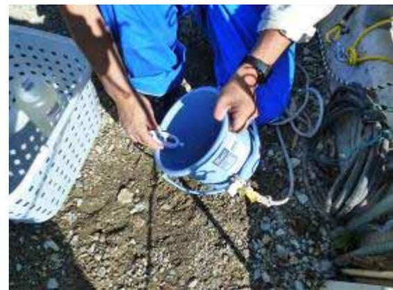
採取試料の水温観測状況
