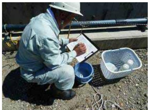
採取試料の水温観測状況
