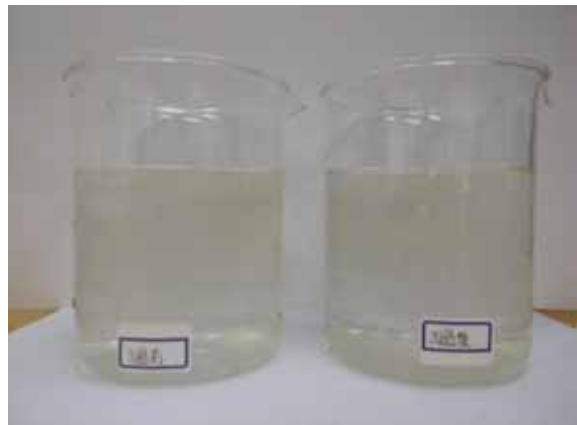
ろ過材通過前後の採水の濁り確認（採水30分後）
