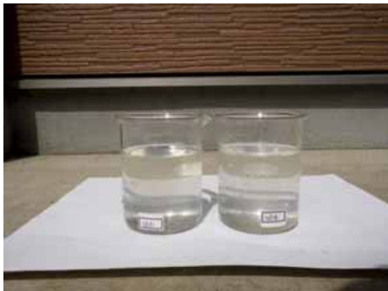
ろ過材通過前後の採水の濁り確認（採水直後）
