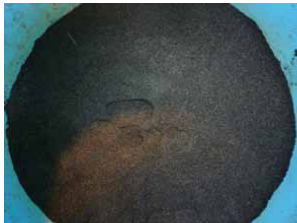
自動活性ろ過器に敷き詰められた活性炭
