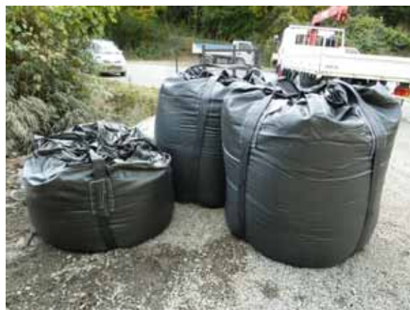
交換する大きな土嚢袋に入った活性炭
