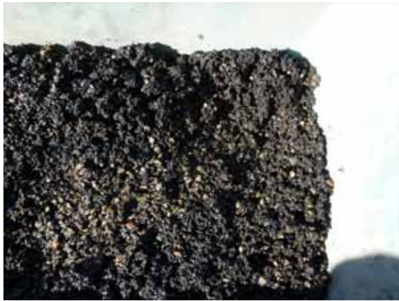
ポンプ車に付着していた交換前の活性炭
